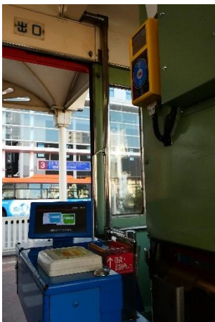
図9：交通系 IC 用端末（右上の黄色い端末）と、い〜カードおよび現金用の運賃箱 (2024 年 3 月神井撮影)
