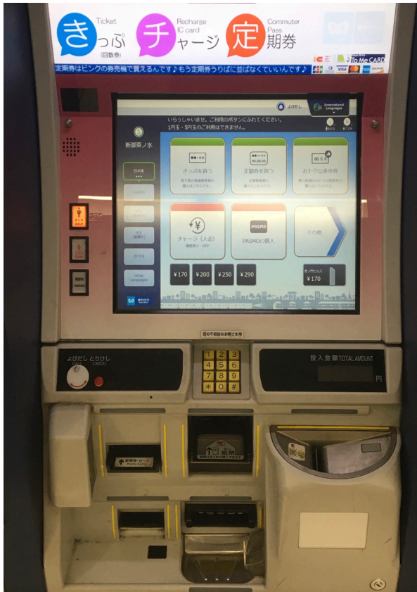
図1 (左)：東京メトロ千代田線・新御茶ノ水駅に設置されている自動券売機。自社線内完結の乗車券はもちろん、都営地下鉄や東武鉄道など他社線への連絡乗車券や定期券の発売も行っているほか、ICカードの新規購入や10円単位でのチャージを行うことのできる機能も搭載されており、乗客のさまざまなニーズに対応可能なものとなっている。
