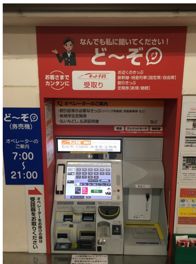
図3：JR鹿兒島本線・水城駅に設置されているMV50型アシストマルス。通常の指定席券売機で可能なきっぷの発売やネット予約したきっぷの受け取りに加えて、オペレーターの呼び出しによる窓口サービスの実施から近距離乗車券の発売まで、幅広い発売業務をこれ1台で完結させることができる。
