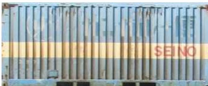
20ft/30ft コンテナは 12ft コンテナより大型で一度に多くの荷物を運ぶことができる。ただし、このコンテナを積載できる貨車が限られるため利用できる線区が限られている。
